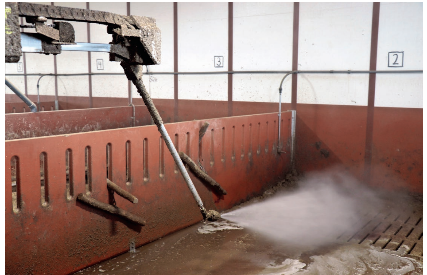
Pesurobotin käyttö vähentää pesemiseen tarvittavaa ihmistyövoimaa. Robotti ei täysin korvaa ihmisen tekemää työtä. Ihmistä tarvitaan edelleen arvioimaan, että pesutulos on hyvä. Pesuroboteista on kerrottu KVMETin numeroissa 3/2019 ja 1/2015.
